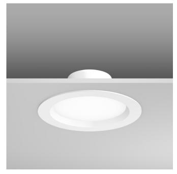
Rundes Einbau-Downlight. Gehäuse Aluminium, kunststoffbeschichtet. Passive Kühlung. Diffusor Kunststoff (Polycarbonat) opal, schlagzäh. MultiColour-Funktion: Farbtemperatur mit rückseitigem Schaltelement einstellbar. Auswahlmöglichkeit 3000 K, 4000 K oder 5700 K. Werkseitig auf 4000 K eingestellt. Werkzeugloser Einbau durch Federbefestigung. Betriebsgeräte eingebaut.
